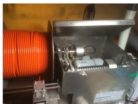
予め決められた測定ポイントに自動航行し、測定ポイントで放射能センサーをウィンチで海底まで下げて測定します。
